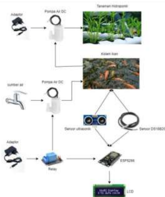
Gambar 3 Rancangan Topologi Akuaponik
