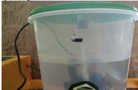
Gambar 10. Pengujian water pump dengan jarak \geq 18 cm
