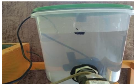
Gambar 11. Pengujian water pump dengan jarak < 5 cm
