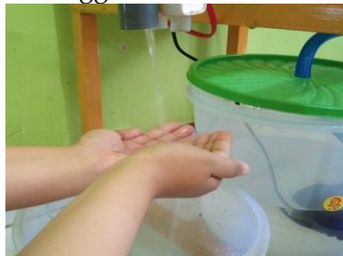
Gambar 8. Pengujian solenoid valve dengan jarak \leq 30
