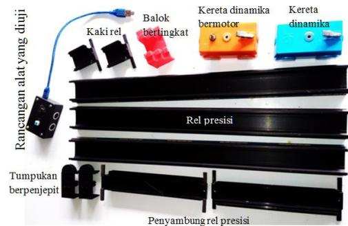
Gambar 5. Peralatan yang diperlukan dalam pengujian
