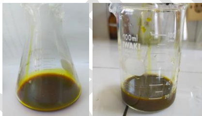
Gambar 2. Pelarutan pasir besi dengan HCl
