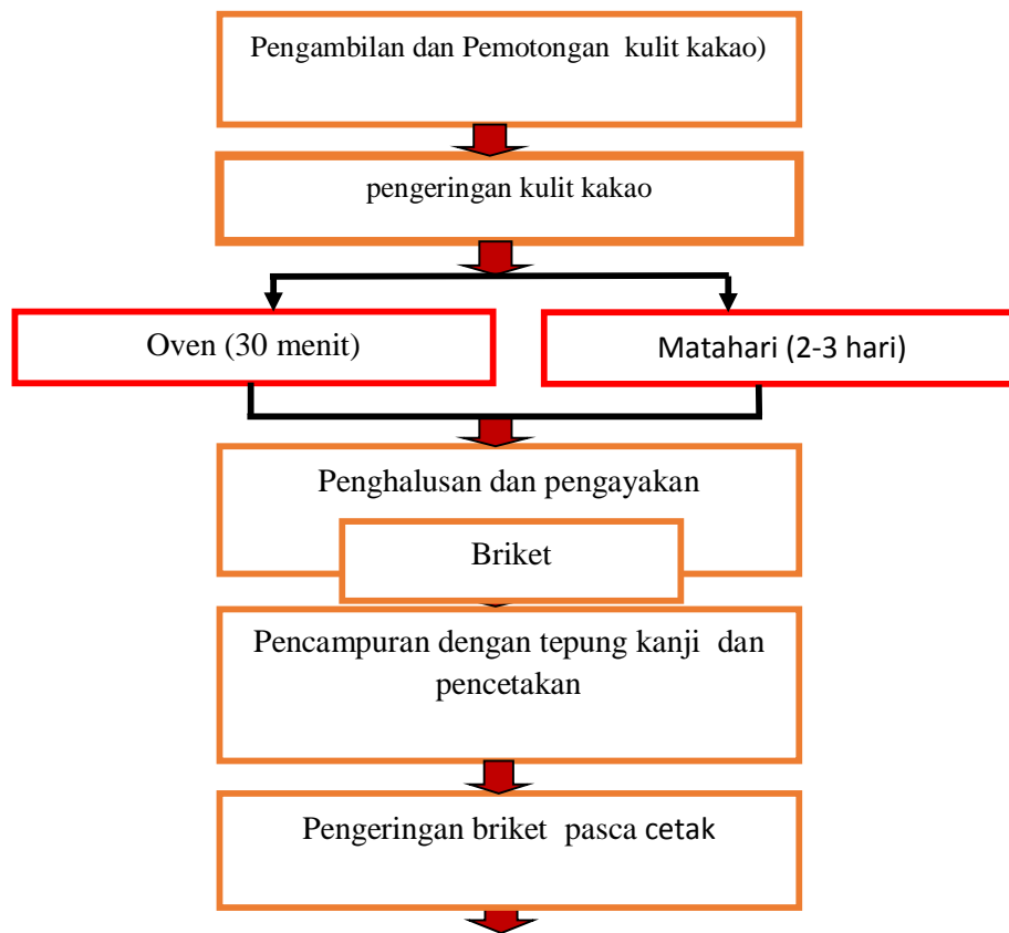
Gambar 1. Tahapan Proses Pembuatan Briket Dari Limbah Kulit Kakao
